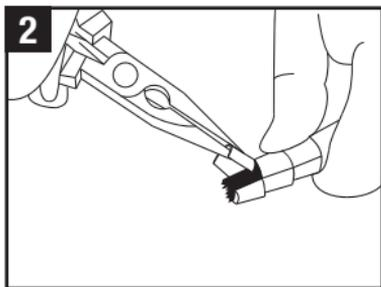
**2** Insert the long nose into the sleeves and lift up the top part of the sleeve. / Insérer le long nez dans le manchon et soulever la partie supérieure du manchon.
